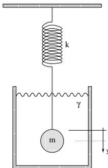
Die Schwingung der Masse im nebenstehenden Bild wird durch die Flüssigkeit gedämpft. Die Bremskraft der Flüssigkeit sei proportional zur Geschwindigkeit der Masse, also  $-\gamma \dot{y}(t)$ .
